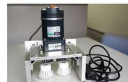
回転寿司のベルトコンベアに付着したご飯粒や海苔の清掃機です。コンベアサイズや高さの調整もスパナ1本でできます。
