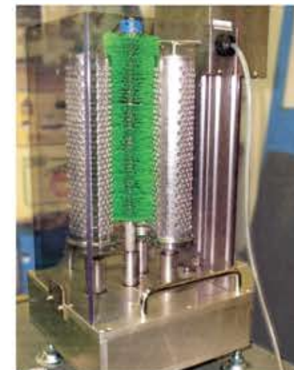
ストレーナーの内外部に付着した異物を洗浄除去するブラッシング装置です。ブラシ軸よりのスプレー式でストレーナー内部の洗浄効果は高く、汚れはタンクに集められるため清潔です。
