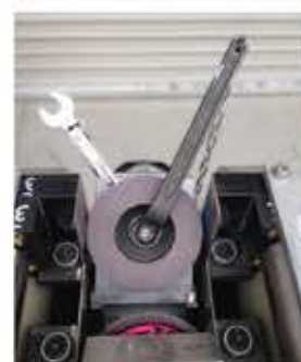
ディスクの交換は付属スパナで行えます。
