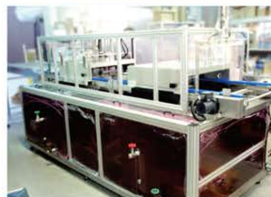
容器の洗浄機です。成型された容器数十個を1組として、連続投入で洗浄できます。
