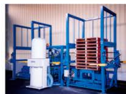
全自動パレットクリーニング装置はパレットの表裏クリーニングを全自動で行います。ほこりや異物の除去はもとより、毛材に砥粒入りを使用していますので、木製表面の目ならしまで行えます。
