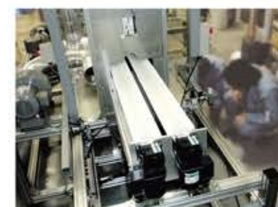
特殊植込方式で、パイプが回転しながら洗浄・搬送される自動洗浄搬送装置です。
