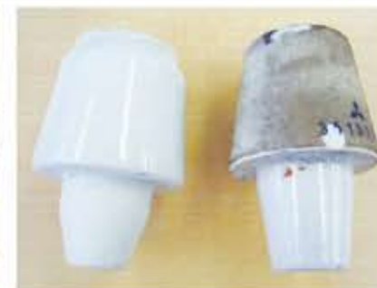
(右)使用済みの汚れた碇子 (左)ブラッシング洗浄後の碇子
