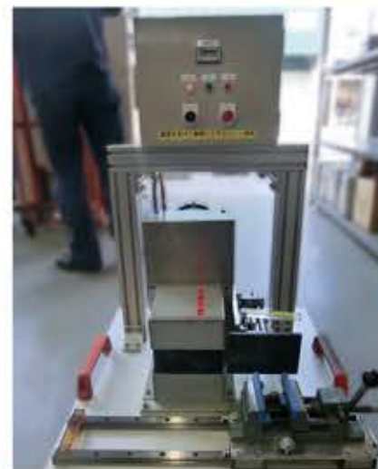
正面(上部に制御盤)
