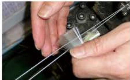
①二つ折れにした針金の中にブラシ毛材を挟みます。
