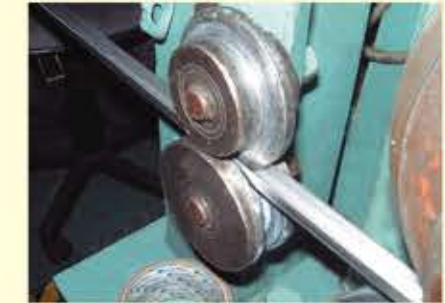
平板コイル材がCH成型機でU字型のチャンネル(CH)を成型します。
