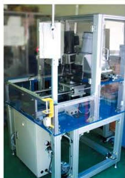
鍛造品の二次加工後のバリ取り機です。製品に過負荷をかけないように内面・外・底面コーナー部を同時に加工します。
