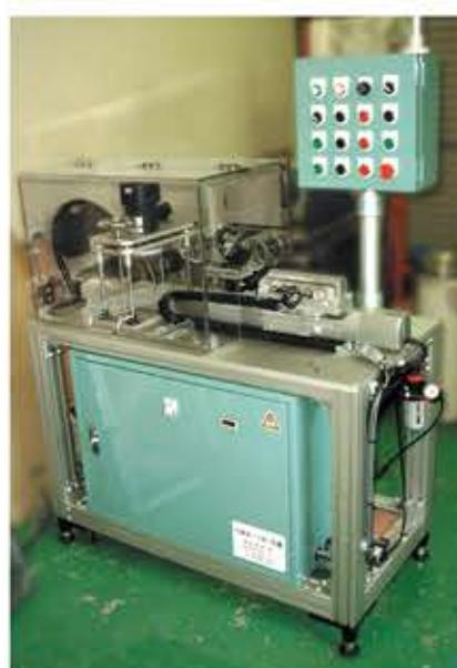
焼結品バリ取り機はロボットによるテーパーラインの除去や面取りを行う機械です。極小の部品をバリ取りするため上下・前後・角度調整・正転逆転・回転スピード調整など、ポイントを絞ったブラッシングを実現しました。
